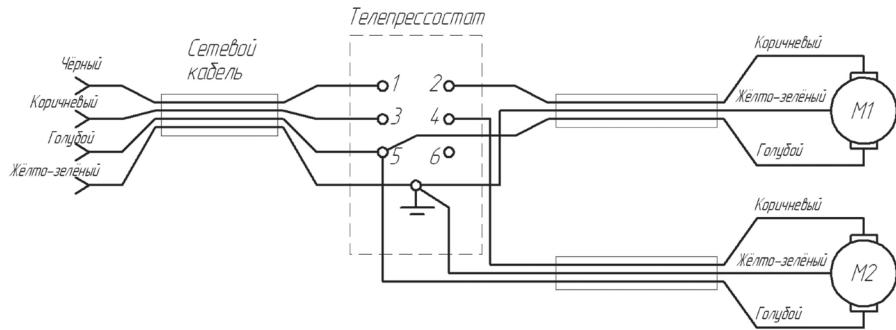
Любодъ из голубых проводов M1 или M2 может быть соединен в телопрессостате с клеммой 6 вместо клеммы 5
